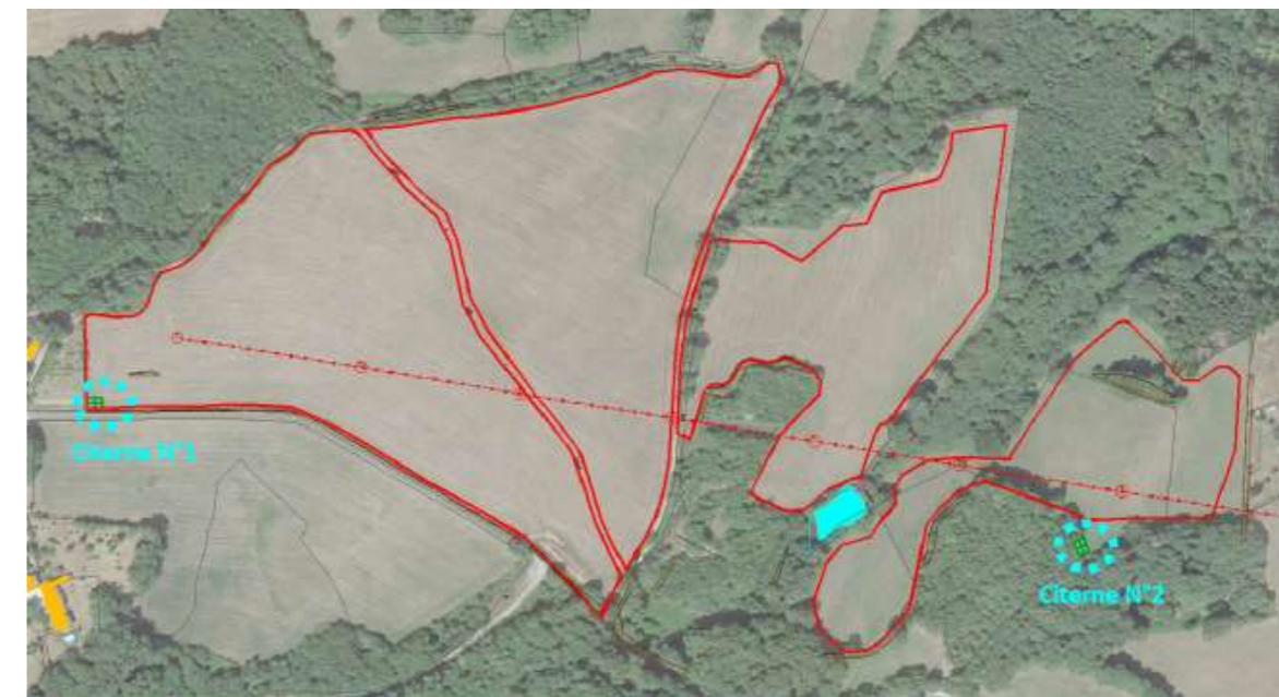
Figure 58 : Position des deux citernes incendie
